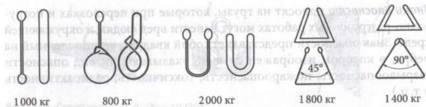
Рис. 1.7. Зависимость грузоподъемности универсальных стропов от способа обвязки
