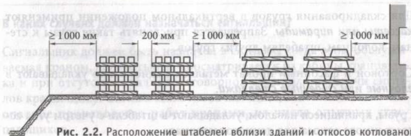
Рис. 2.2. Расположение штабелей вблизи зданий и откосов котлованов
